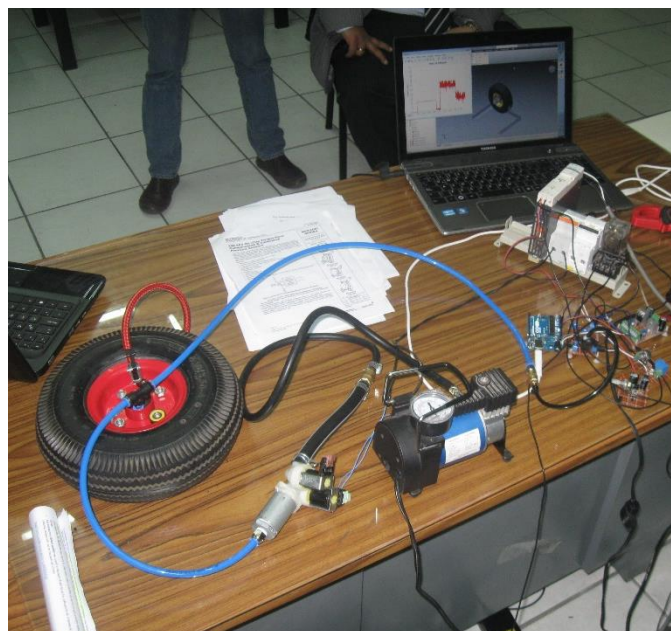
Figura 6. Implementación del sistema de inflado automático
