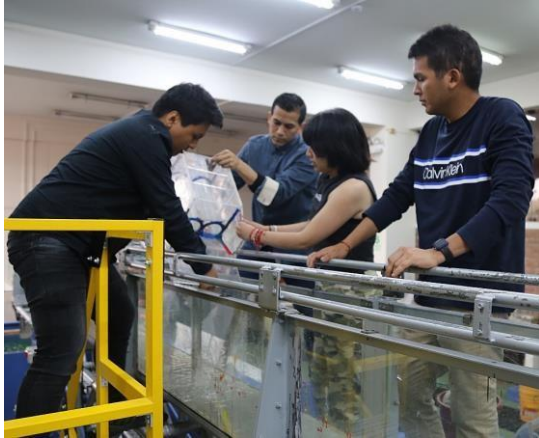
Figura 8: Colocación del prototipo de alcantarilla en el canal de pendiente variable
