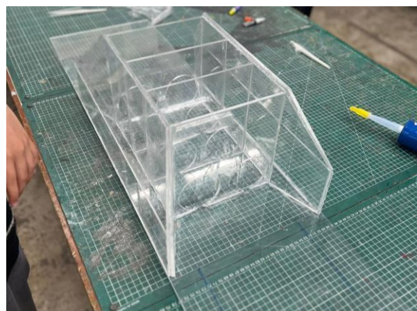
Figura 7: Prototipo final de prototipo de alcantarilla escala reducida
