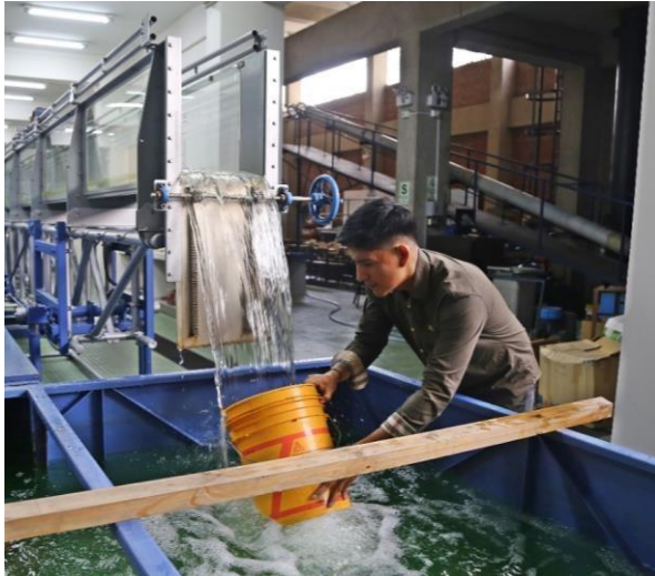
Figura 12: Aplicación del método volumétrico
