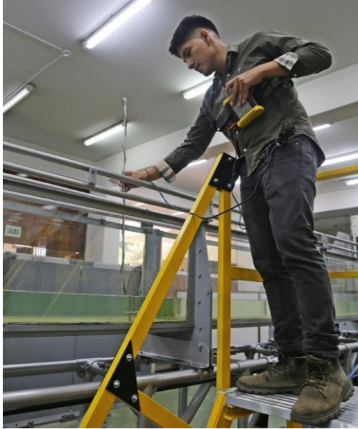
Figura 10: Colocación del correntómetro para calcular las velocidades del agua Elaboración propia
