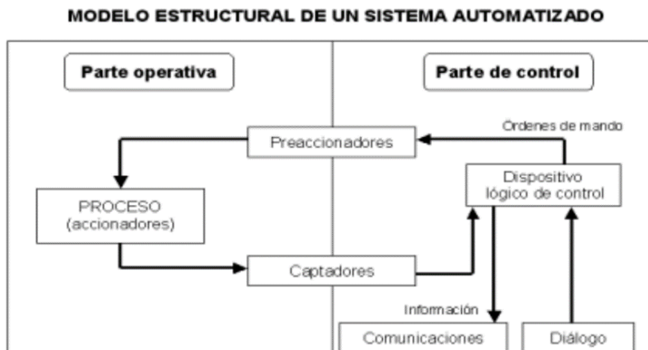
Figura 1: Modelo estructural de un sistema automatizado
