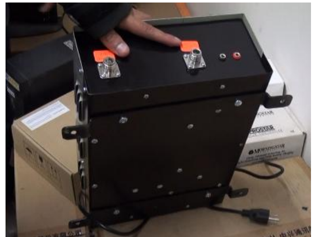
Repetidor de 20dBm para cubrir las zonas oscuras (lugar donde no se tiene buen nivel de recepción)
